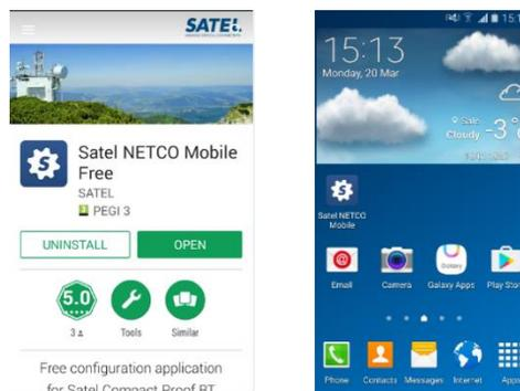
Для использования модема SATEL Compact-4BT с Bluetooth нужно сначала выполнить его сопряжение с устройством пользователя, на котором установлено приложение SATEL NETCO. Процедура сопряжения аналогична процедуре сопряжения, которая обычно используется на других устройствах с Bluetooth, на устройствах с ОС Android сопряжение выполняется через меню “Settings” (настройки) → “Bluetooth”.
