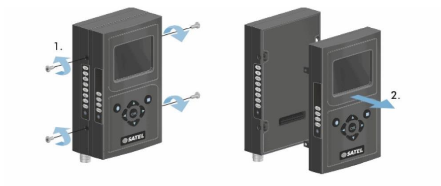
Рис. 1.4 Модульная конструкция, монтаж центрального модуля (ЦМ)
