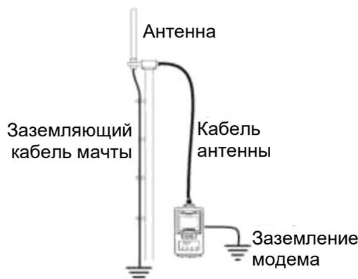
Рис. 1.11 Заземление антенны
