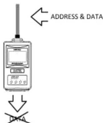
Адресация приёма включена, но и первичный, и вторичный адрес приёма радиомодема не соответствуют адресу принимаемого пакета данных.
