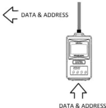
Адрес передачи включен. Радиомодем добавляет первичный адрес передачи в начало пакета данных.
